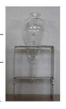
Ces éprouvettes de sédimentation permettent le contrôle de la concentration en poudre (fluorescente ou colorée) des produits de magnétoscopie. Ce contrôle se fait à réception (produit neuf) ou en cours d'utilisation, sur produit base pétrole ou base aqueuse. Pour les contrôles des produits fluorescents, l'ASTM E709 impose une éprouvette de sédimentation avec une graduation de 0,05 ml.
